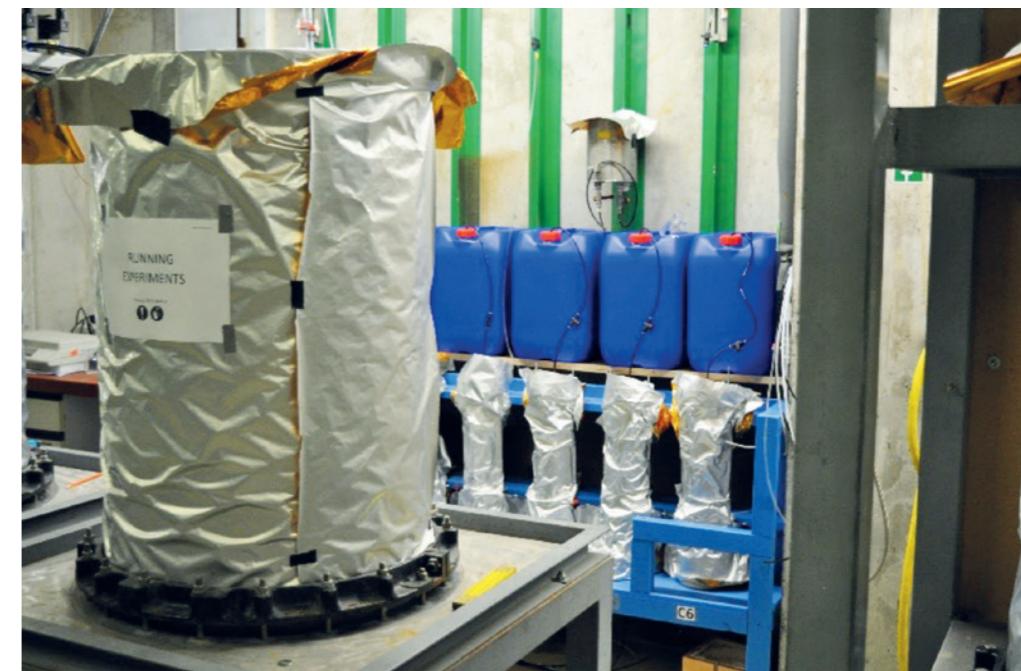
Versuchsaufbau zur PFAS-Immobilisierung (Säulenversuch). (Quelle: PD Dr. Claus Haslauer)
